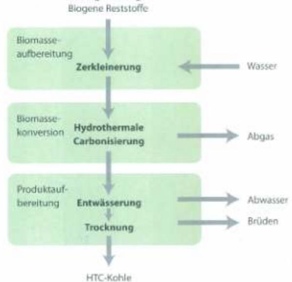
Abbildung 2: Verfahrensschritte der HTC-Anlage
